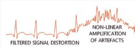
Herkömmliche Holter-Rekorder tendieren dazu, das Rauschen mehr zu verstärken als das tatsächliche Signal. Zum Ausgleich dieses Effekts wird das Signal oftmals stark gefiltert, was zu weiteren Verfälschungen und starken morphologischen Veränderungen (QRS-Breite, Form von P- und T-Welle) führt.
