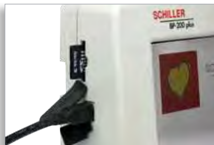
USB-Schnittstelle für die Wartung und die Kalibrierung des Gerätes sowie SD-Karten-Schnittstelle für Software-Updates und Rohdaten
